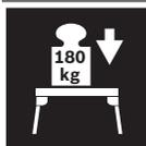
工作台最大承載能力（電動工具 + 工件）是 **180 kg**。
