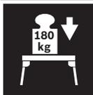
A capacidade máxima de carga (ferramenta elétrica + peça) da mesa de trabalho é de **180 kg**.
