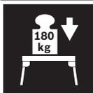
La capacité de charge maximale (outil électroportatif + pièce) du support de travail est de **180 kg**.
