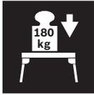
ความสามารถในการรับน้ำหนักสูงสุด (เครื่องมือไฟฟ้า + ชิ้นงาน) ของโต๊ะทำงาน คือ **180 กก.**
