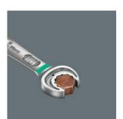
Doppelsechskant-Die clevere Geometrie des Jokers macht die Verbindung mit Schraube oder Mutter formschlüssig - das sitzt. Und die auswechselbare, gehärtete Metallplatte im Maul des Jokers verbeißt sich mit extrem harten Spitzen in die Schraube. Beides verringert die Abrutschgefahr auch bei hohen Drehmomenten.
