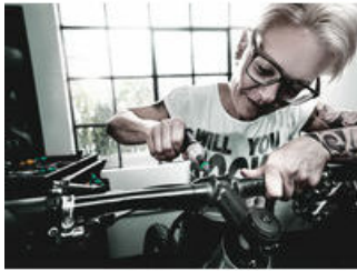
Voreingestellte, einstellbare Drehmomentschraubendreher
