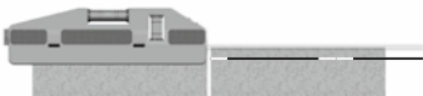
Voor het leggen van wandtegels wordt het apparaat op de eerste tegel gezet met behulp van de klemhouder, die via de pennen aan de achterzijde kan worden uitgeschoven. De laserstraal, die parallel aan de horizontale libel ligt, gaat langs de tegelrand. Zo kan de tegel met de libel exact worden uitgelijnd.
