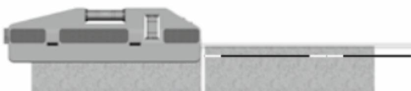
Para assentar azulejos de parede, o aparelho é encaixado no primeiro azulejo, através do suporte de aperto elástico, que pode ser empurrado para fora através dos pinos na traseira. O feixe laser, paralelo ao nível horizontal, é conduzido ao longo da aresta do azulejo. Assim é possível alinhar exatamente o azulejo com o nível.
