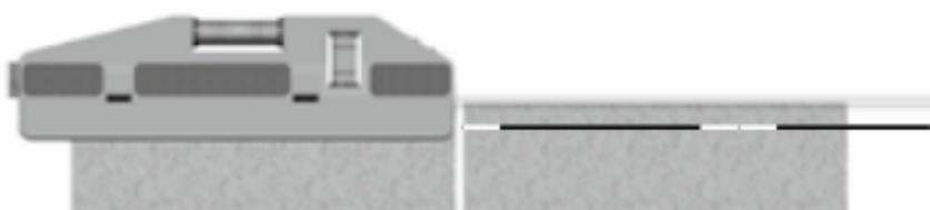
För läggning av väggkachel sätts apparaten fast på den första kakelplattan med hjälp av fjäderklämfästet, som kan justeras med stiften på baksidan. Laserstrålen, som ligger parallellt mot horisontallibellen, går längs kakelkanten. På så sätt kan kakelplattan riktas upp med libellen.
