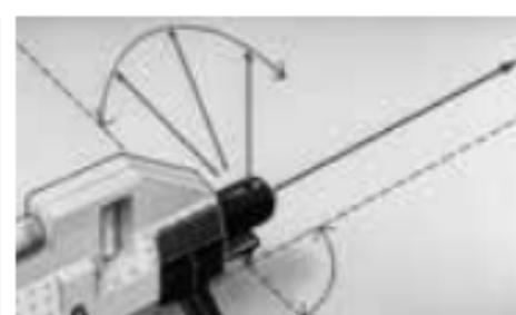
Med 90° strålfördelare kan laserstrålen dessutom vridas 90°.
