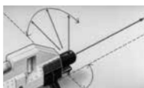
Mit dem 90° Strahlteiler lässt sich der Laserstrahl zusätzlich um 90° umleiten.
