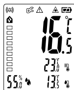
Ympäristö-/pintalämpötilan ero: \geq 6,5 °C kylmäsilta, sininen väri näytössä, -merkki vilkkuu
