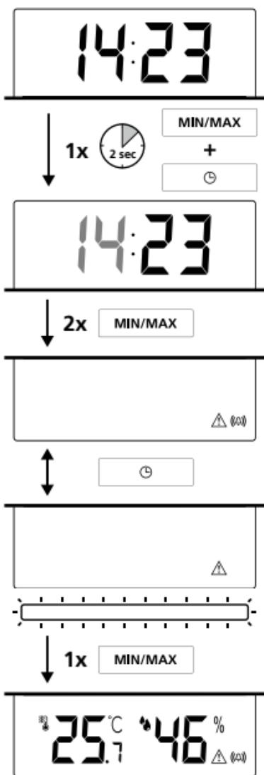
Advarselen mot luftfuktighet kan innstilles som akustisk alarm, visuell alarm eller en kombinasjon av begge i menyen. Ved høye eller lave verdier for luftfuktighet over lengre tid vises alarmsymbolet i displayet, og det sendes en visuell og/eller akustisk advarsel med visse mellomrom. For å spare energi og for å unngå feil, sendes ikke alarmen kontinuerlig.
