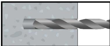
1. Loch bohren mit Bohrhammer
