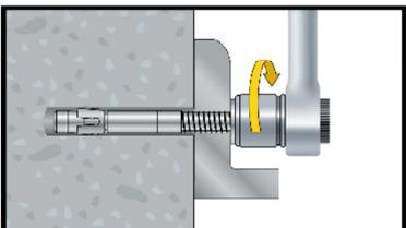
4. Mutter mit Drehmomentenschlüssel bis zum Drehmoment  $T_{inst}$  festziehen
