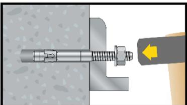
3. Anker mit Hammer ins Bohrloch setzen (Mindestsetztiefe beachten)
