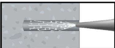
2. Reinigen des Bohrlochs vom Bohrmehl
