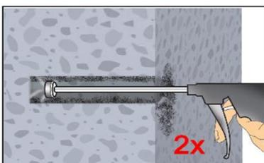
**2d.** Das Bohrloch vom Bohrlochgrund her 2x vollständig mit Druckluft (min. 6 bar) (Anhang B 4) ausblasen, bis die ausströmende Luft staubfrei ist. Wird der Bohrlochgrund nicht erreicht, muss eine Verlängerung verwendet werden.
