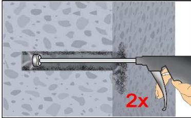
2f. Abschließend das Bohrloch erneut vom Bohrlochgrund her 2x vollständig mit Druckluft (min. 6 bar) (Anhang B 4) ausblasen, bis die ausströmende Luft staubfrei ist. Wird der Bohrlochgrund nicht erreicht, muss eine Verlängerung verwendet werden.
