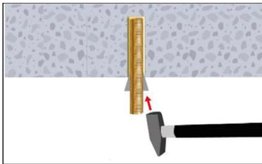
11. Bei Überkopfmontage ist die Ankerstange bis zum Start der Aushärtung zu fixieren (z.B. Holzkeile).
