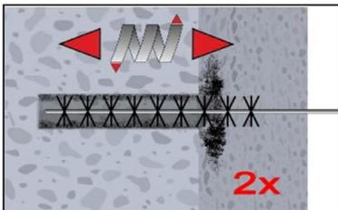
**2b.** Bürstendurchmesser prüfen (Tabelle B4). Das Bohrloch ist mit geeigneter Drahtbürste  $> d_{b,min}$  (Tabelle B4) minimum 2x mit Drehbewegungen auszubürsten.
