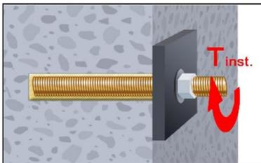
13. Nach vollständiger Aushärtung kann das Anbauteil mit bis zu dem maximalen Drehmoment (Tabelle B1 oder B3) montiert werden. Die Mutter muss mit einem kalibriertem Drehmomentschlüssel festgezogen werden. Bei der Vorsteckmontage kann optional der Ringspalt zwischen Ankerstange und Anbauteil nachträglich mit Mörtel verfüllt werden. Dafür Unterlegscheibe durch Verfüllscheibe ersetzen und Mischerreduzierung auf den Mischer stecken. Der Ringspalt ist verfüllt, wenn Mörtel austritt.
