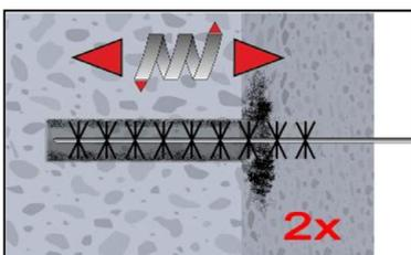
**2e.** Bürstendurchmesser prüfen (Tabelle B4). Das Bohrloch ist mit geeigneter Drahtbürste  $> d_{b,min}$  (Tabelle B4) minimum 2x mit Drehbewegungen auszubürsten.
