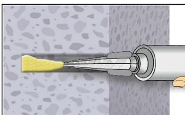
6. Gereinigtes Bohrloch vom Bohrlochgrund her ca. zu 2/3 mit Verbundmörtel befüllen. Langsames Zurückziehen des Statikmischers aus dem Bohrloch verhindert die Bildung von Luftpöcken. Wird der Bohrlochgrund nicht erreicht, muss eine passende Mischerverlängerung verwendet werden. Die temperaturrelevanten Verarbeitungszeiten (Tabelle B5) sind zu beachten.
