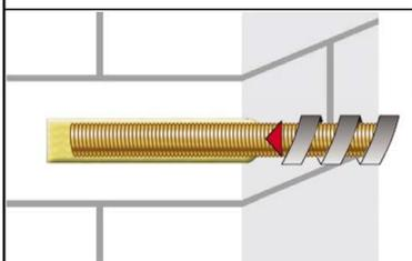
7. Befestigungselement mit leichten Drehbewegungen bis zur festgelegten Setztiefe einführen. Die Ankerstange muss frei von Schmutz-, Fett, Öl und anderen Fremdmaterialien sein.
