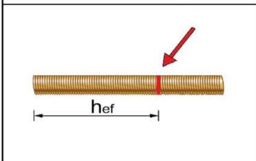
2. Vor dem Einsetzen der Ankerstange ist die Verankerungstiefe auf der Ankerstange zu markieren.
