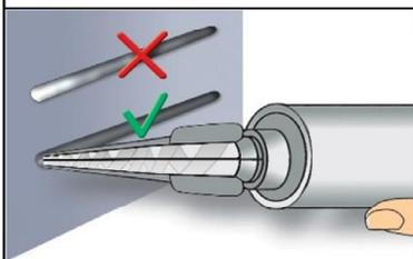
3. Der Mörtelvorlauf ist nicht zur Befestigung der Ankerstange geeignet. Vor dem Injizieren ins Bohrloch, unvermischten Mörtel solange werfen, bis sich eine gleichmäßige graue Mischfarbe eingestellt hat, jedoch mindesten 3 volle Hübe, bei Schlauchfolien 6 volle Hübe.
