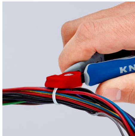
Mit dem Elektronik-Seitenschneider den Kopf des Kabelbinders abschneiden...
