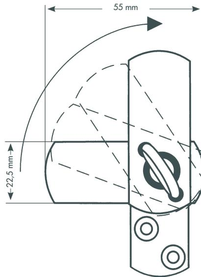
Drehmechanismus des Schenkels. Durch einfaches Hineindrücken des Schlüssels wird entriegelt.
