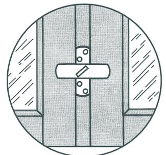
**S 20**, Knebel aus Aluguß, für einflügelige Fenster und Türen für 18 mm Überschlaghöhe, weiß oder braun, mit Drahtschlüssel zum Entriegeln, mit 4 Edelstahlschrauben 4,5 x 50 mm, mit 2 Distanzstücken 85 x 22 x 1 mm und 85 x 22 x 2,5 mm
