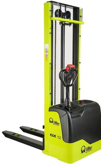
Die neue GX Baureihe ist die ideale Deichselstapler Lösung für den gewerblichen Gelegenheitseinsatz auf kleineren bis mittleren Lagerflächen. Mit einer Gesamtbreite von nur 800 mm und der seitlich angeordneten Deichsel ist der neue GX äußerst wendig, standfest und ermöglicht immer freie Sicht zu den aufzunehmenden Lasten. Integrierte Batterien und das integrierte HF-Ladegerät machen den GX zur kompletten Lösung Ihrer Lageraufgaben.
